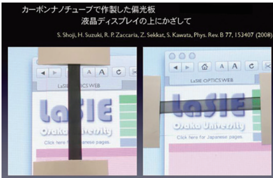
図2 カーボンナノチューブを一軸配向して作製した紫外・可視・近赤外用偏光板
