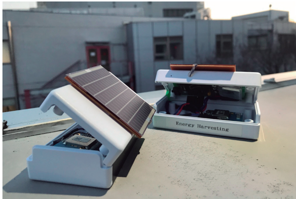
太陽光から電力を集めて通信するエナジーハーベスティングシステム
