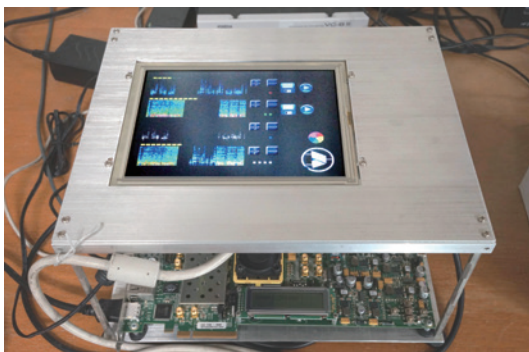
スマートミキサーの試作機。専用の演算回路で高性能化を実現。液晶画面で2次元上の信号を確認しつつ好みの音にも調整可能。
