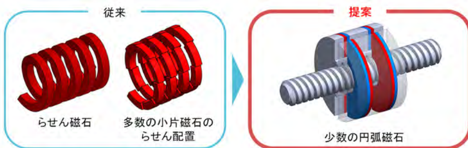
図 3 従来構造と提案構造の比較
