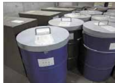
PCB廃棄物の保管状況
