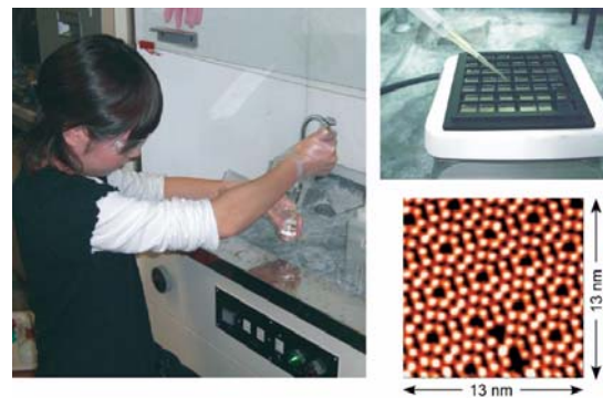
シリコン微粒子の基板上堆積と清浄 Si 表面の STM 像
