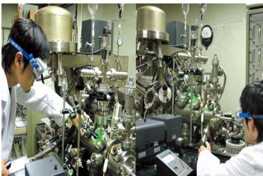
パルスレーザーを用いた半導体微粒子作製
