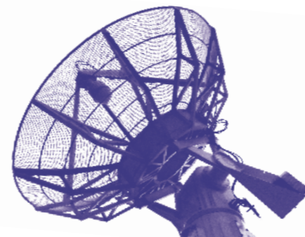
宇宙・電磁環境研究センターの菅平宇宙電波観測所が有する人工衛星追尾用のパラボラアンテナ。
