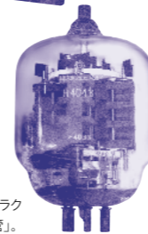
電通大の教員・山中惣之助が試作・開発した「フラクショナル真空管」。
